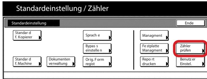
4b) Der Gesamtzählerstand wird unter dem Abschnitt „Total Count“ aufgeführt.
