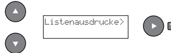
3b) Mit der Taste **[Rauf]** oder **[Runter]** den Menüpunkt „Statusseite“ auswählen und 2x **[OK]** drücken, um den Ausdruck zu starten.
