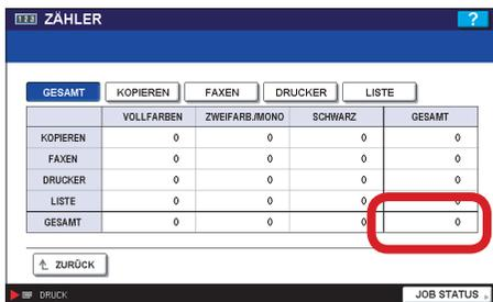
3b) Der Gesamtzählerstand wird unter dem Abschnitt „Total“ in der rechten Spalte „Total“ aufgeführt.
