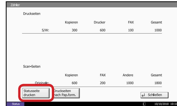
3b) Der Zählerstand (Page Count) wird unter dem Abschnitt „Zähler“ aufgeführt.
