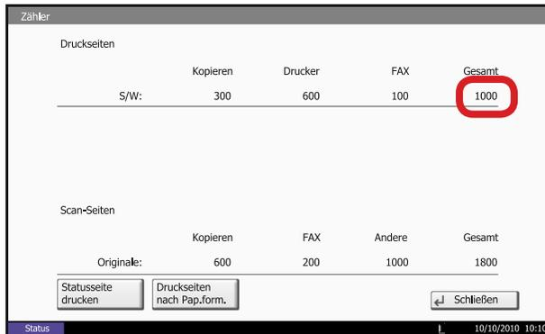
3b) Der Gesamtzählerstand wird unten links unter „Gesamtzahl gedr. S“ aufgeführt.
